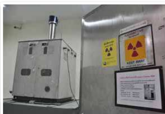
• ภาพแสดงการใช้ประโยชน์จากเครื่องฉายรังสีแกมมา โคลบอลต์-60
