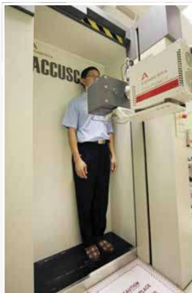
• ภาพแสดงเครื่อง Whole Body Counter สำหรับการตรวจวัดปริมาณรังสีภายในร่างกายและต่อมไทรอยด์
