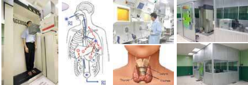
ภาพแสดงเครื่องและห้องปฏิบัติการ Whole Body Counter สำหรับการตรวจวัดปริมาณรังสีภายในร่างกายและต่อมไทรอยด์
