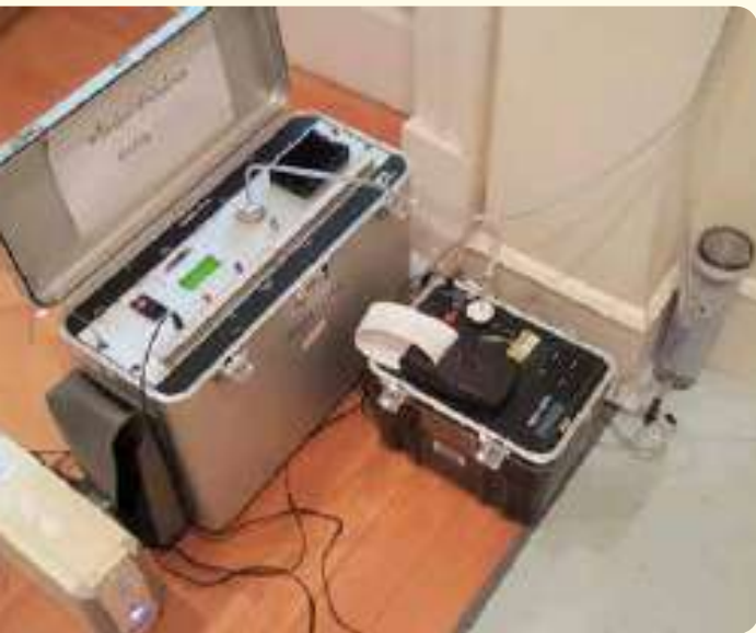
ภาพที่ 2: การตรวจวัดเรดอนภายในอาคาร
