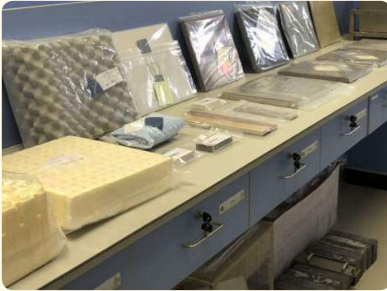
ภาพที่ 3: ตัวอย่างวัสดุต่างๆ ที่นำมาวัดอัตราการปล่อยเรดอน
