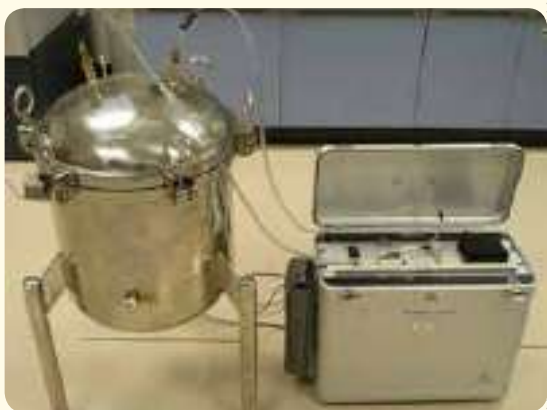
ภาพที่ 1: การตรวจวัดเรดอนในวัสดุต่างๆ
