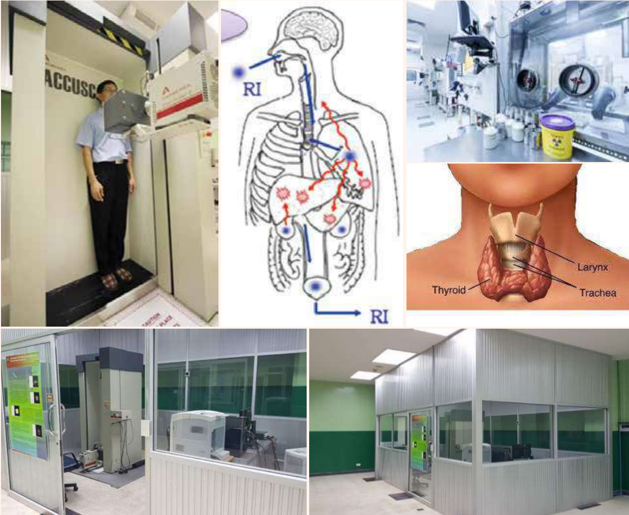
ภาพแสดงเครื่องและห้องปฏิบัติการ Whole Body Counter สำหรับการตรวจวัดปริมาณรังสีภายในร่างกายและต่อมไทรอยด์
